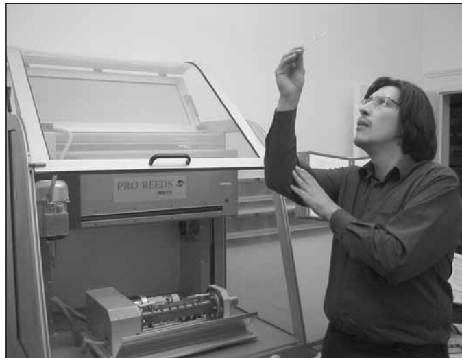
Prüfender Blick am Herzstück von Pro Reeds: Eine CNC-Maschine zur hochpräzisen und schonenden Bearbeitung der Schilfhölzer. Mehrere Anspitzungen und über 50 Fassons sind derzeit in der Datenbank.
